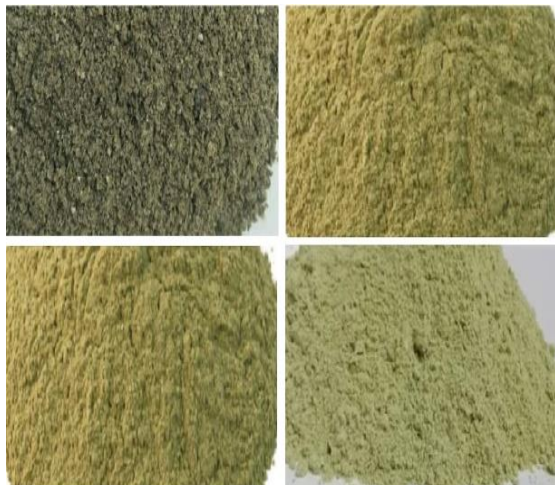
Fig. 1. Images of BP powder (a) 400 μm, (b) 300 μm, (c) 150 μm, and (d) 100 μm
